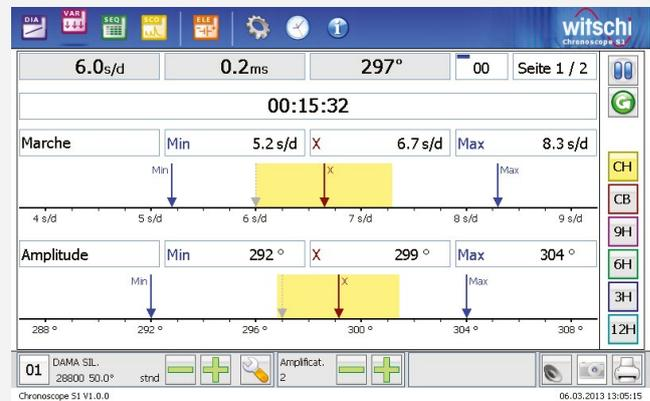
Le mode Vario mesure la stabilité de la marche, de l'amplitude et du repère sur une période étendu. Ce mode d'affichage est un supplément idéal pour un contrôle rapide ou plus longue (jusqu'à 100 heures).
