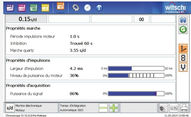
Avec le capteur optionnel pour montres électroniques "Microphone à Quartz", de très nombreuses montres électroniques peuvent être mesurées sans contact. Dans le cas de montres à quartz analogiques, on mesure la marche instantanée, la période d'inhibition, la marche corrigée, le niveau de puissance et la largeur d'impulsion du moteur. La marche instantanée des montres à écran à cristaux liquides et des montres à diapason peut également être déterminée.
